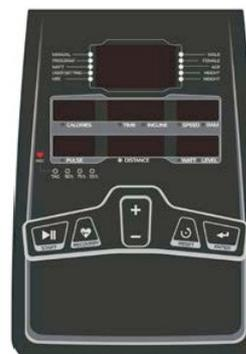
Fonctionnement Pour connaître le taux de récupération de la fréquence cardiaque, effectuer des tests après un intervalle de temps, appuyer sur le bouton pendant 1 minute. Une fois la durée écoulée, le boîtier de commande électronique attribue des points à l'état physique F1-F6.
